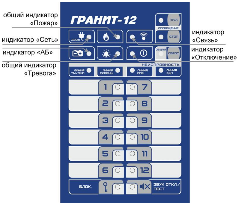
Рис.2 Панель индикации и управления прибора Гранит-12А GSM
